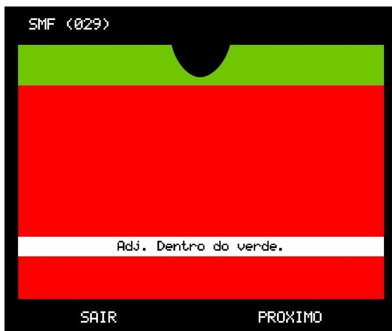
Ajuste o eletrodo superior de forma que fique dentro da área verde ou do lado de fora. Mas não deve ser visível na área vermelha.
