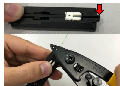
Coloque no gabarito e decape a fibra a partir da marcação indicada
