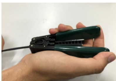
Decape na marcação de 5cm
