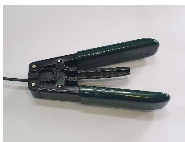
Decape na marcação de 5 cm
