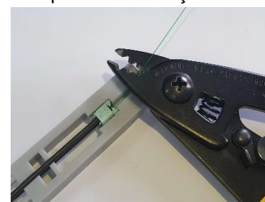
Insira o guia no gabarito e decape a fibra a partir da marcação indicada
