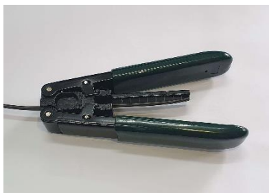
Decape na marcação de 5cm
